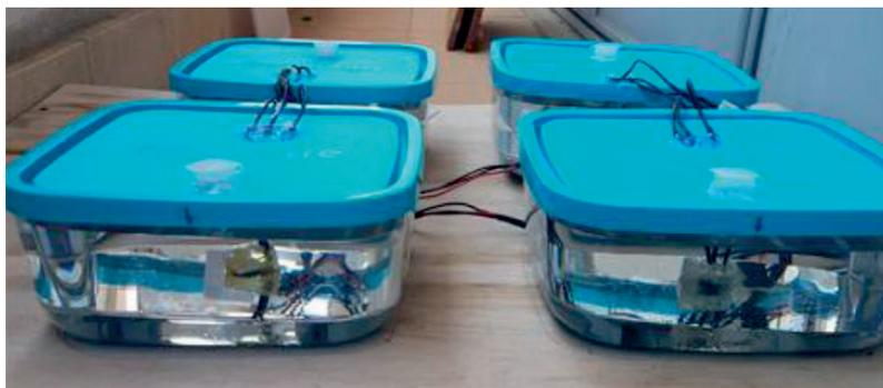
Figura 23 - Immersione dei provini in soluzioni corrosive
